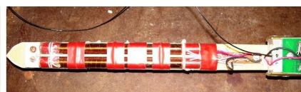
Блок измерений электромагнитного излучения
