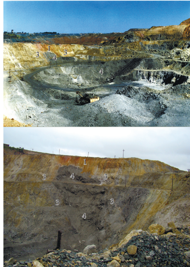
Рис. 3. Фрагмент измененных пород (1) в северном борту карьера (северо-западная зона) в 2000 г. (вверху) и 2008 г. (внизу).
