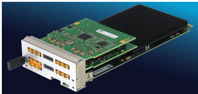
Рис. 7. Внешний вид модуля ПОР NAT-AMC Fig. 7. Appearance of the SDR NAT-AMC module
