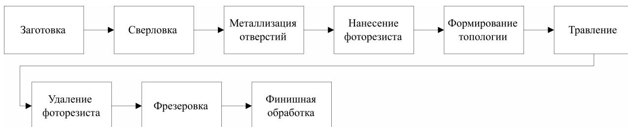
Рис. 2. Блок-схема технологического процесса изготовления плат трансформатора и спиральной антенны
