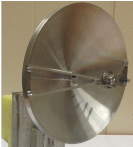
Рис. 7. Внешний вид антенны Кассегрена на частоту 220 ГГц Fig. 7. The appearance of the Cassegrain antenna at a frequency of 220 GHz
