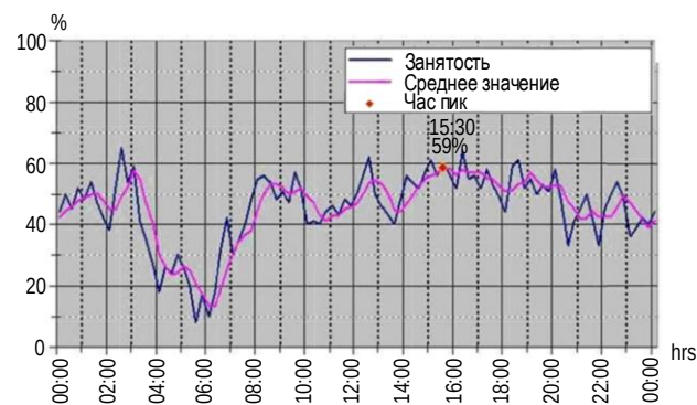
Рис. 5. Типовая структура трафика в одном частотном канале (копия рисунка 15 из [2])
