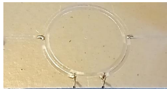
Рис. 11. Макет КЭР с возбуждением волны через направленные ответвители
