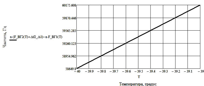
Рис. 13. Изменение разностной частоты (при использовании десятих гармоник частоты сигналов ВГ1 и ВГ2) в диапазоне температур от минус 40 °С до минус 39 °С
