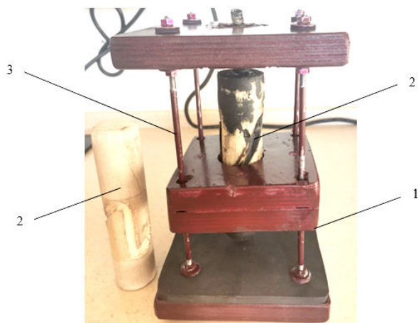
Рис. 6. Модель механизма ударно-поворотного действия: 1 — шайба; 2 — штанга (справа показана штанга с канавками); 3 — направляющие канавки
