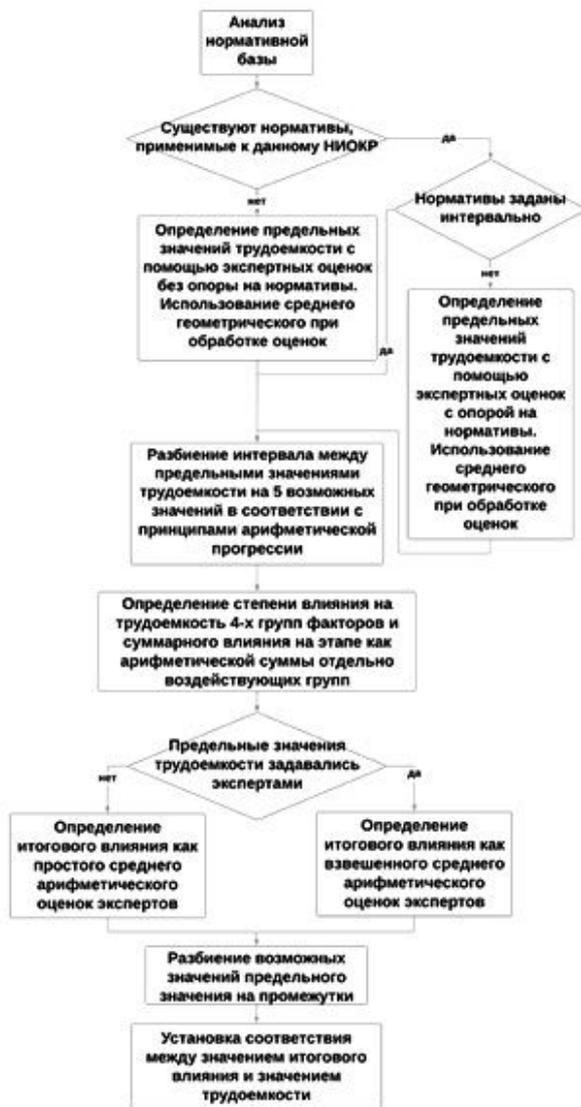
Рис. 3. Схема определения трудоемкости этапов и подэтапов НИОКР
