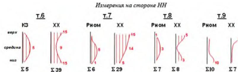
Рис. 6. Результат измерений значений деструкции (Δ, дБ, указаны на кривых) по баку на НН
