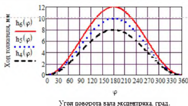
Рис. 6. Графики хода толкателя для вала с эксцентриситетами 6 мм, 5 мм и 4 мм
