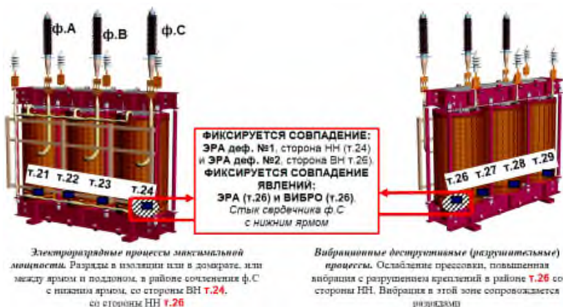
Рис. 3. Анализ взаимного влияния ЭРА и ВИБРО явлений в дефекте по точкам измерения для определения их совпадения в обобщенной зоне
