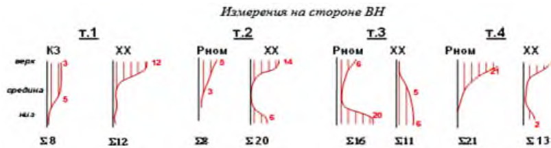
Рис. 7. Результат измерений значений деструкции (Δ, дБ, указаны на кривых) по баку на ВН
