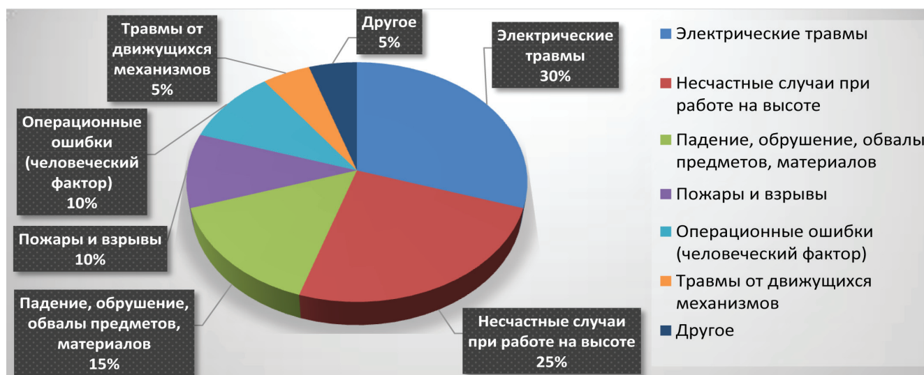
Рисунок 3. Виды происшествий, приводящих к несчастным случаям на объектах электроэнергетики, подконтрольных Ростехнадзору
