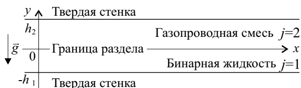
Рис. 1. Схема течения Fig. 1. Flow sketch
