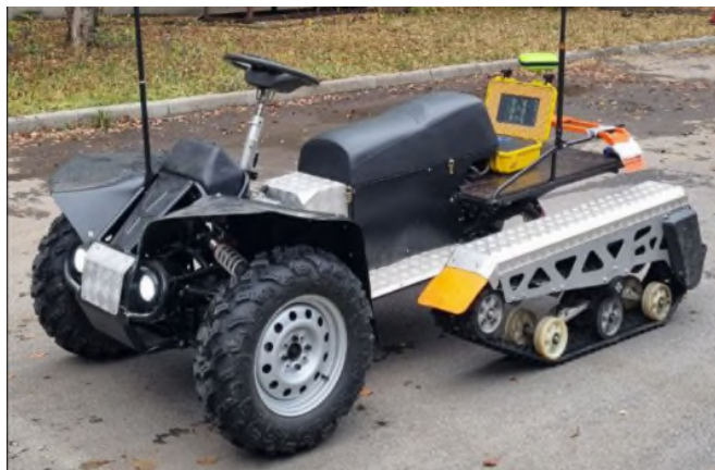
Рис. 1. Колесно-гусеничная платформа для сбора данных
