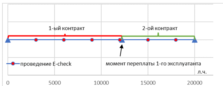
Рис. 4. Иллюстрация непропорциональности длительности контракта и количества выполненных тяжёлых форм ТОиР
