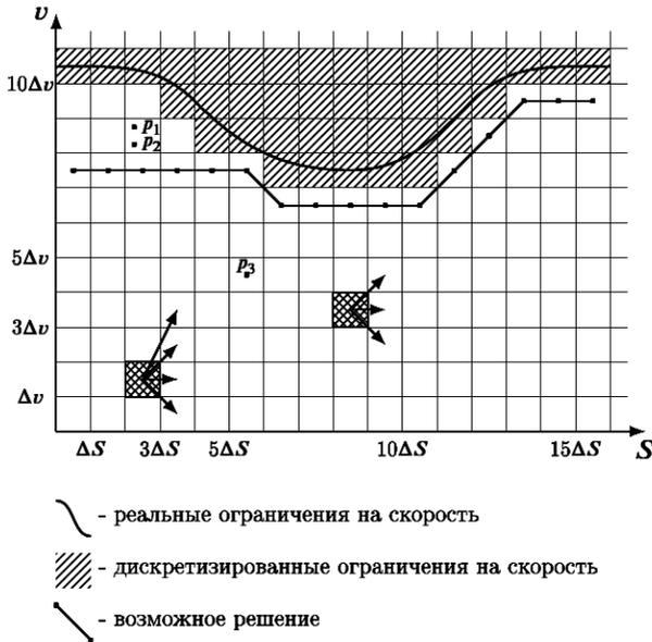
Рис. 8. Пример построения решения методом DP и пример допустимых переходов между состояниями в дискретизованном  $S$ - $V$ -пространстве
