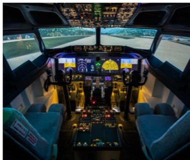
Рис. 6. Кабина АТ с ИВО с составным четырёхканальным безочковым  $3D^{(V_2)}$ -индикатором из четырёх безочковых одноканальных  $3D^{(V)}$ -индикаторов с «широким зрачком»
