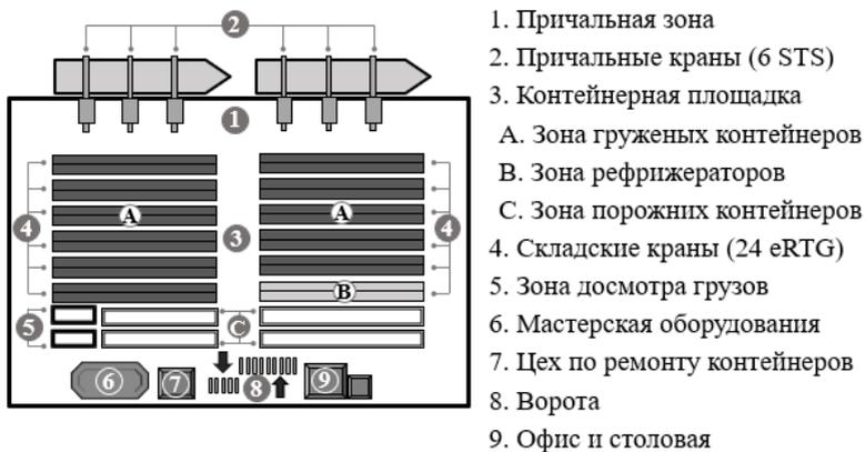
Рис. 2. Функциональная схема
