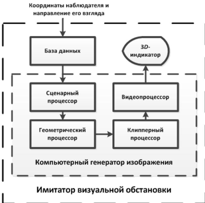
Рис. 1. Схема имитатора визуальной обстановки
