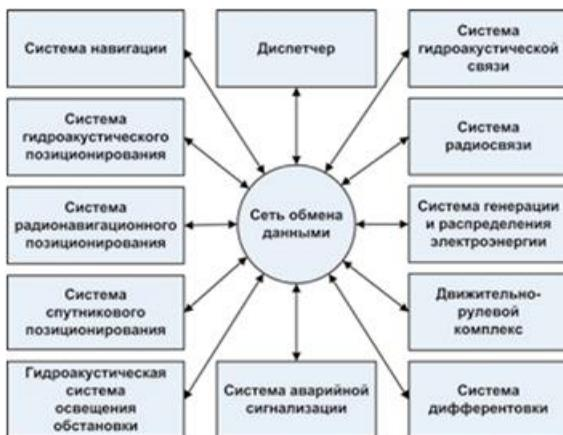
Рис. 1. Схема системы управления АНПА [17]
