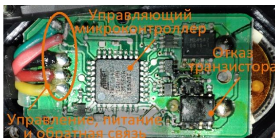
Рис. 6. Вид печатной платы ЭМРП с отказавшим блоком электроники при длительном статичном удержании момента торможения
