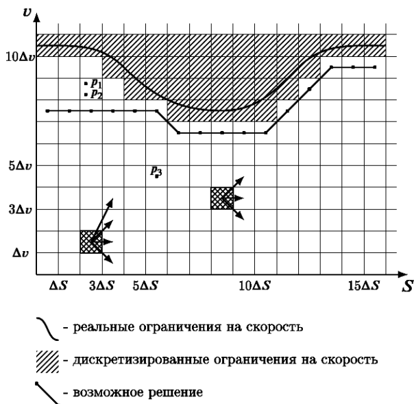
Рис. 8. Пример построения решения методом DP и пример допустимых переходов между состояниями в дискретизованном S – V -пространстве
