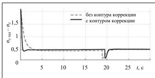
Рис. 12. Графики отклонений фактических значений параметра n_y от заданных значений n_{y \text{ зад}} при нелинейной модели аэродинамических коэффициентов
