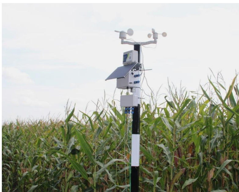
Рис. 4. Полевая метеостанция для ИИС «Умное поле»
