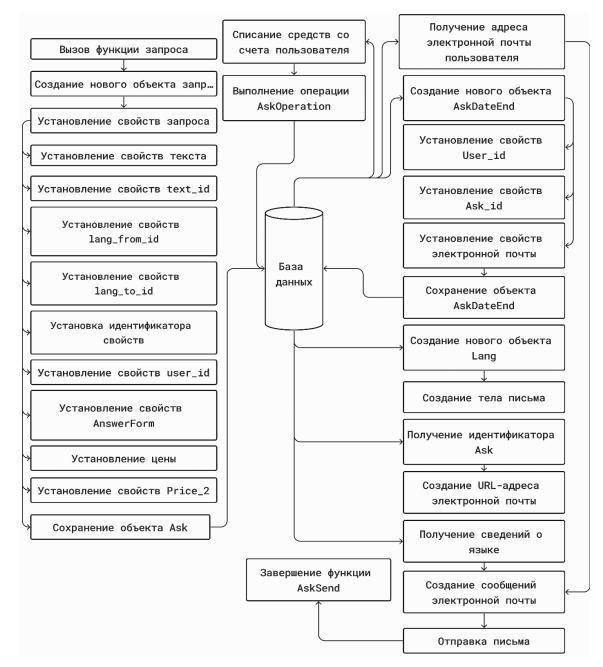
Рис. 2. Алгоритм обработки запросов распределенной системы
