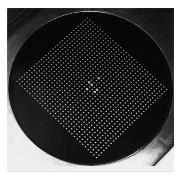
**Рис. 4.** Полученное камерой изображение паттерна (рис. 3), прожженного на подложке
