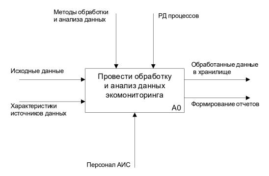
**Рис. 1.** Диаграмма уровня A-0. Обобщенная функциональная модель процессов обработки и анализа исходных данных в системе экомониторинга
