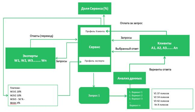
**Puc. 1.** Схема распределенной системы обработки аннотированной информации **Fig. 1.** Scheme of a distributed system for processing annotated information
