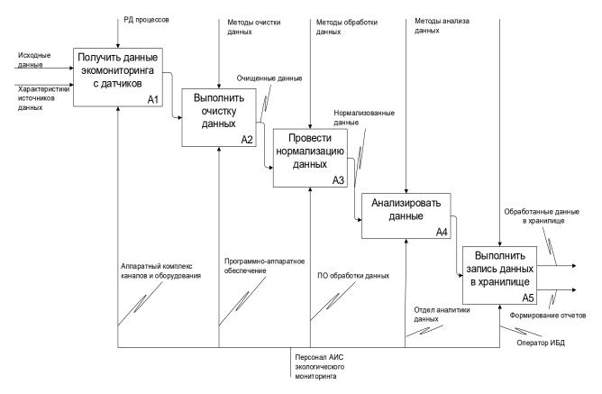
**Рис. 2.** Диаграмма уровня A1. Детализация информационных процессов обработки данных в автоматизированной информационной системе экомониторинга (ИБД – информационная база данных, РД – регламентирующая документация)
