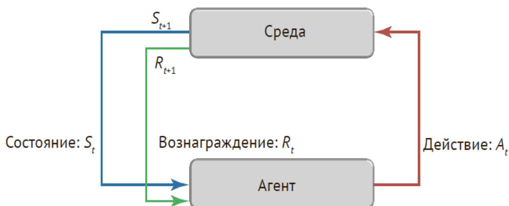
Рис. 1. Структура процесса обучения с подкреплением: агент взаимодействует с окружающей средой (совершает действие, ощущает состояние и получает вознаграждение) [6]
