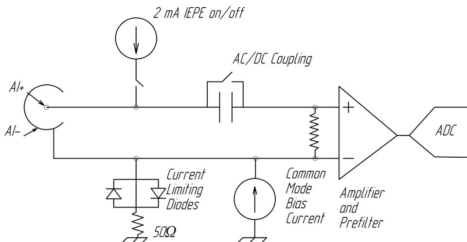
Рис. 3. Входная цепь NI 9250 для одного канала
