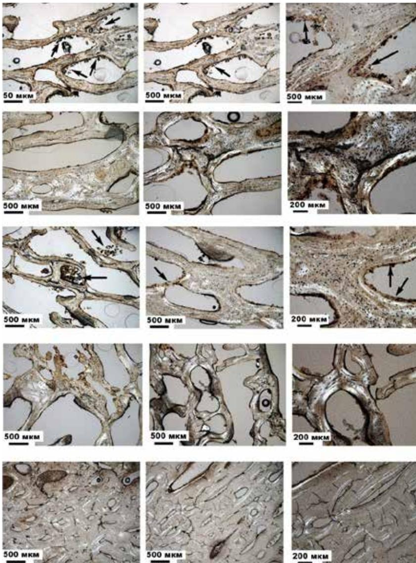
Рисунок 6. Микроструктура костей мамонта под оптическим микроскопом в режимах параллельных и скрещенных николей. Стрелками показано заполнение микрополостей минеральными зернами.
