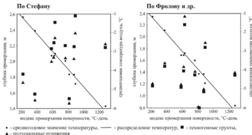
Рисунок 4. Распределение рассчитанной глубины промерзания.
