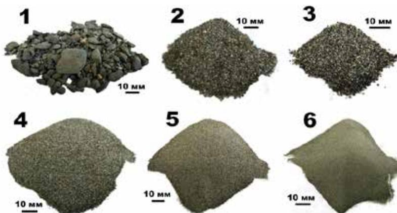
Рисунок 3. Гранулометрический состав аллювиальных осадков, вмещающих и перекрывающих скелет мамонта: 1–6 – гранулометрические фракции: 1 – гравийно-галечная; 2 – грубозернистого песка; 3 – крупнозернистого песка; 4 – среднезернистого песка; 5 – мелкозернистого песка; 6 – тонкозернистого песка и алеврита.
