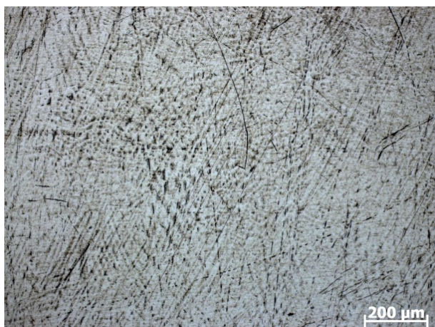
Рис. 2. Микроструктура образцов, полученных с помощью WAAM-технологии
