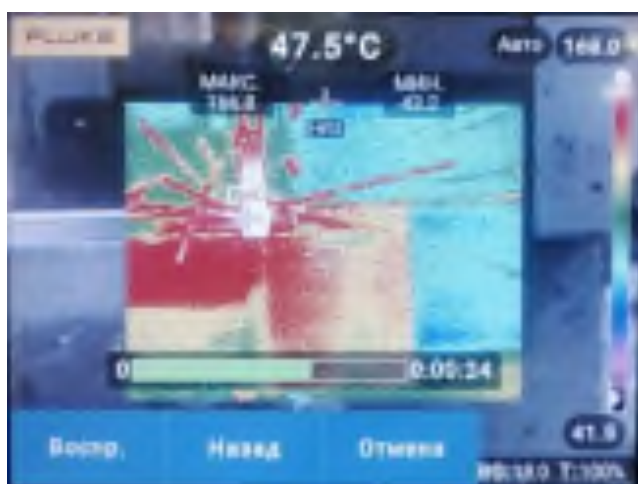
Рис. 9. Пример измерения температуры для 8000 об/мин (а) и 10 000 об/мин (б) тепловизором Fluke Ti400
