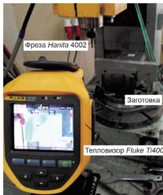
Рис. 8. Экспериментальная система для измерения температуры
