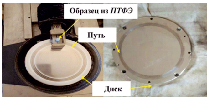
Рис. 4. Изображение дорожки износа, образованной образцами на диске из нержавеющей стали марки AISI 304
