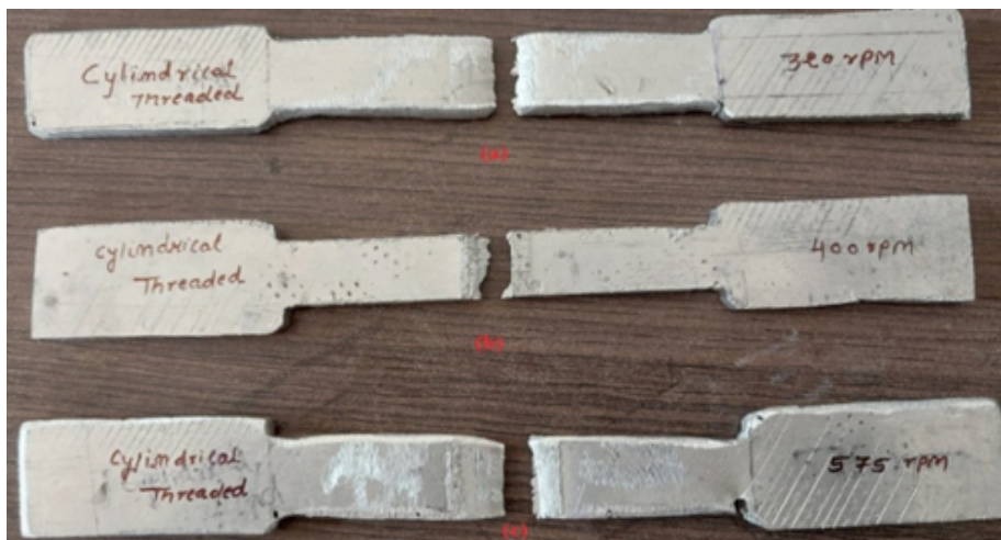
Рис. 5. Разрушенные образцы после испытания на растяжение соединений, полученных с использованием инструмента с наконечником в форме цилиндра с резьбой
