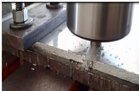
Рис. 2. Пластическое течение материала в процессе СТП
