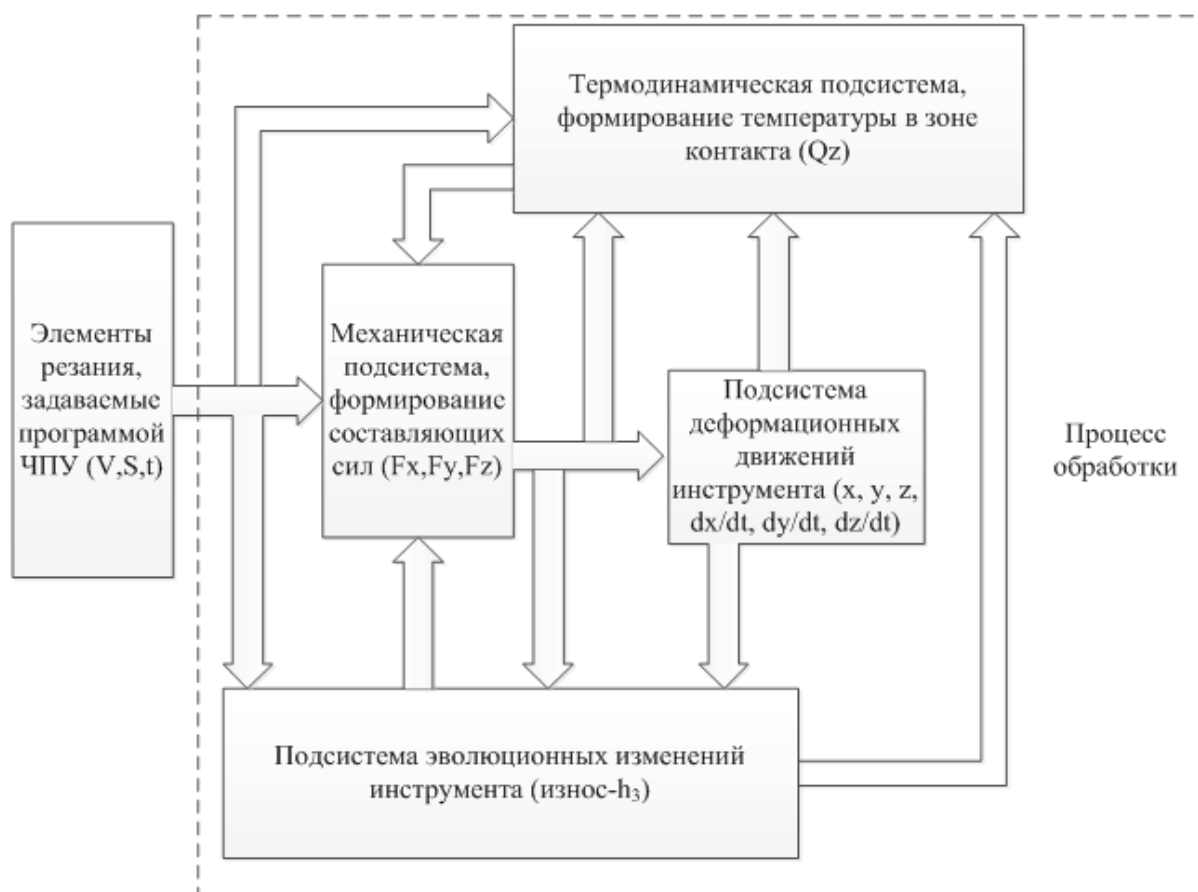
Рис. 9. Структура процесса обработки как системы
