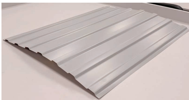
Рис. 3. Прогиб гофрированного листа в поперечном сечении вверх:
