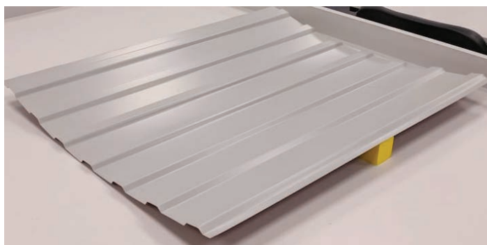
Рис. 4. Прогиб гофрированного листа в поперечном сечении вниз:
