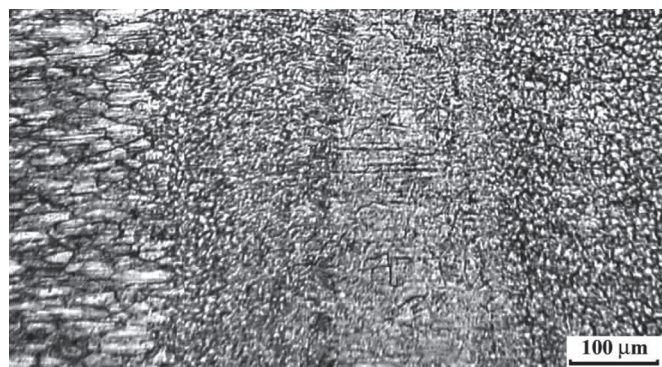
Рис. 4. Микроструктура полос сварного шва алюминиевых листов толщиной 35,0 мм
