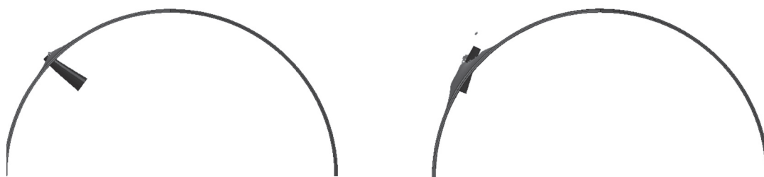
Рис. 8. Положение имитатора лопатки. Сплав – ОТ4-0. Толщина стенки корпуса 6 мм: a – удар в корпус; б – локализация имитатора после удара
