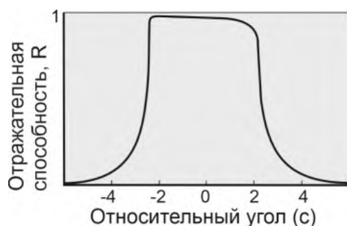
Рис. 7. Кривая отражательной способности оптического элемента монохроматора
