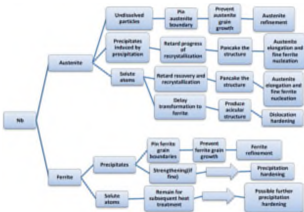
Рис. 7. Роль ниобия в сталях HSLA в процессе термомеханической обработки
