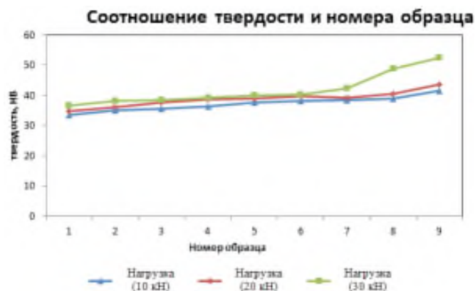
Рис. 2. Изменение твердости в зависимости от нагрузки
