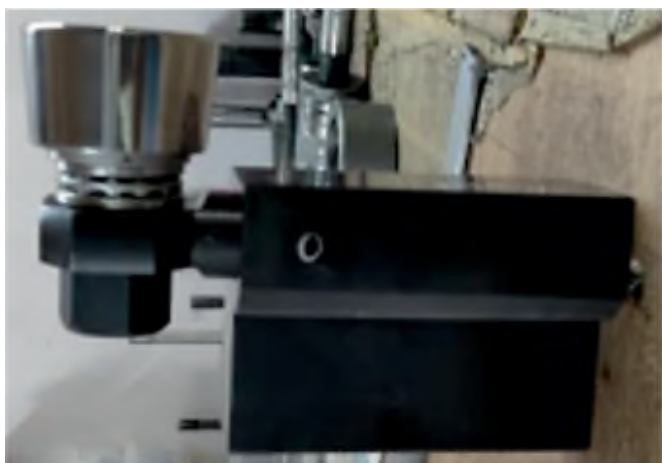
Рис. 1. Инструмент для накатывания роликом, использованный в настоящем исследовании
