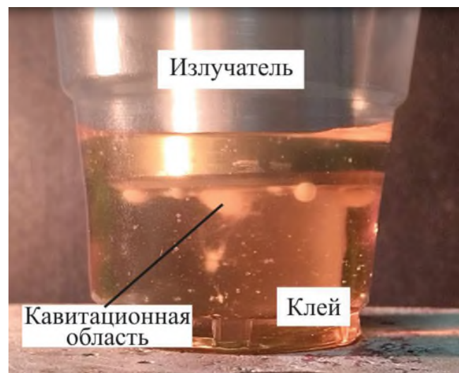
Рис. 2. Ультразвуковая обработка клея
