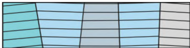
Рис. 6. Демонстрация мозаичности кристалла на примере пяти блоков, разориентированных друг относительно друга под небольшими углами
