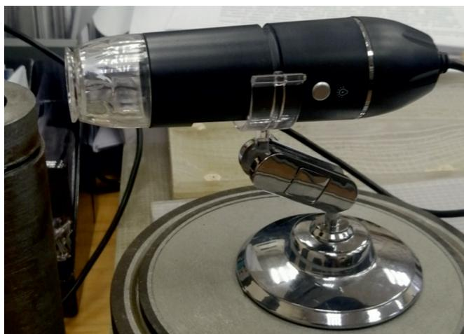
Рис. 2. Электронный USB-микроскоп
