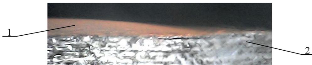
Рис. 3. Капля СОЖ на поверхности стальной заготовки:
