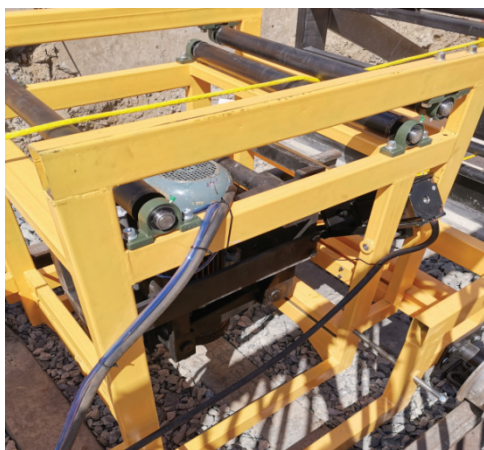
Рис. 8. Устройство шлифовальной тележки:
