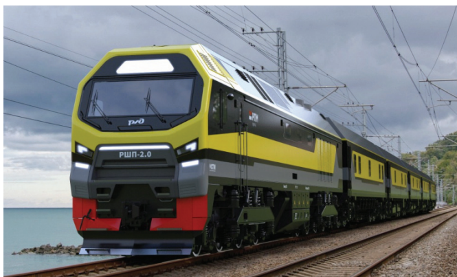
Рис. 2. Рельсошлифовальный поезд РШП 2.0
