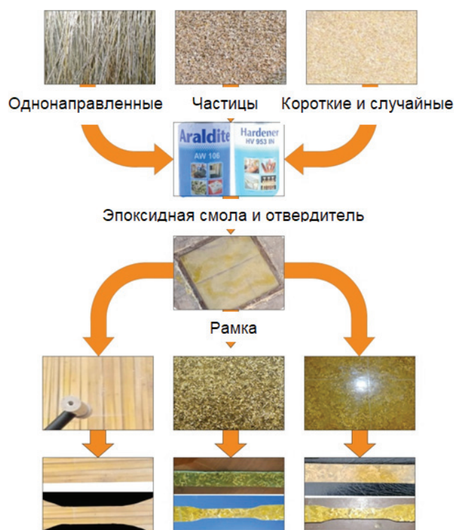
Рис. 2. Процесс изготовления слоистых КМ
