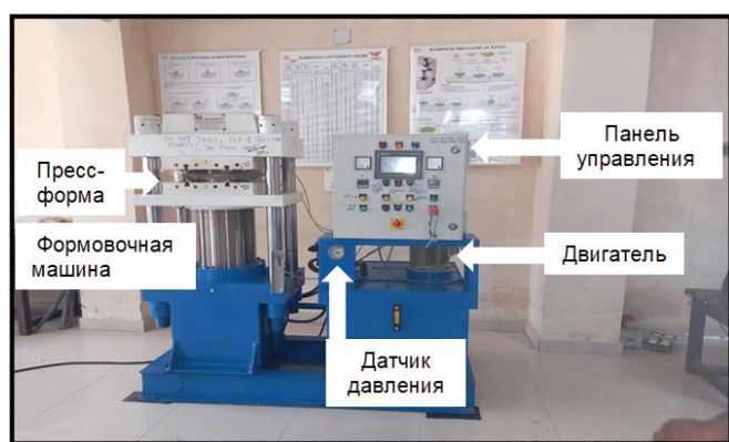
Рис. 1. Компрессионная формовочная машина
