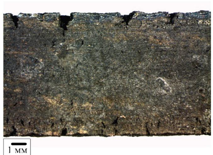
Рис. 6. Стереомикроскопическое изображение образца, прокатанного с током,  $j = 580 \text{ A/mm}^2$ ,  $e = 1,47$
