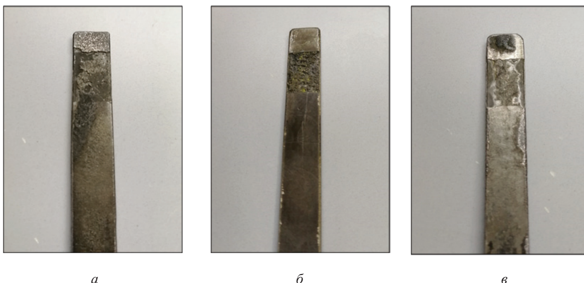
Рис. 4. Поверхность образцов в результате химического травления образцов из стали 3Х2В8Ф после ХТО:
