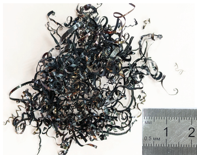
Рис. 1. Внешний вид стружки после фрезерной обработки заготовки из стали 45
