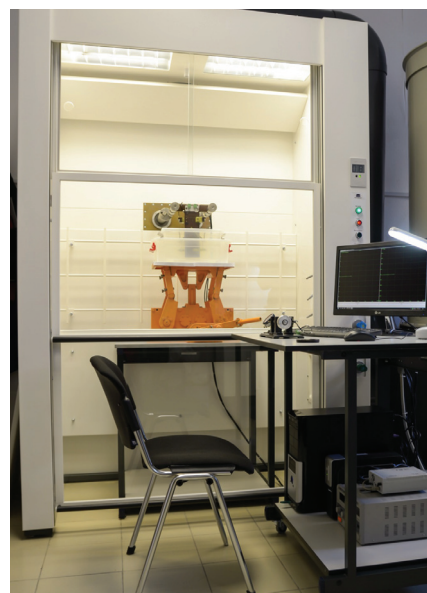
Рис. 2. Установка для измерения остаточных напряжений механическим методом УДИОН-2
