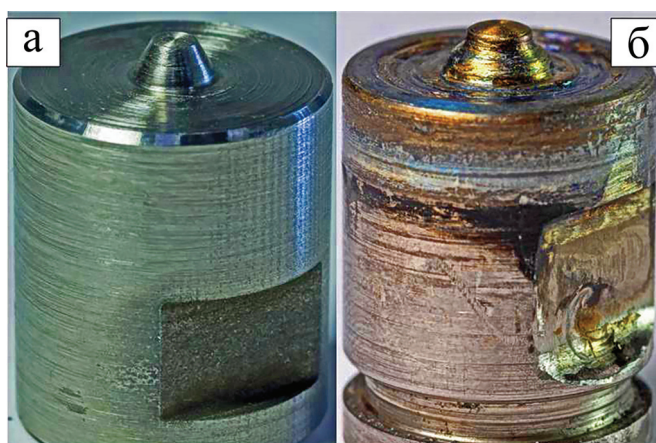
Рис. 8. Инструмент СТП из жаропрочного сплава ЖС6У:
