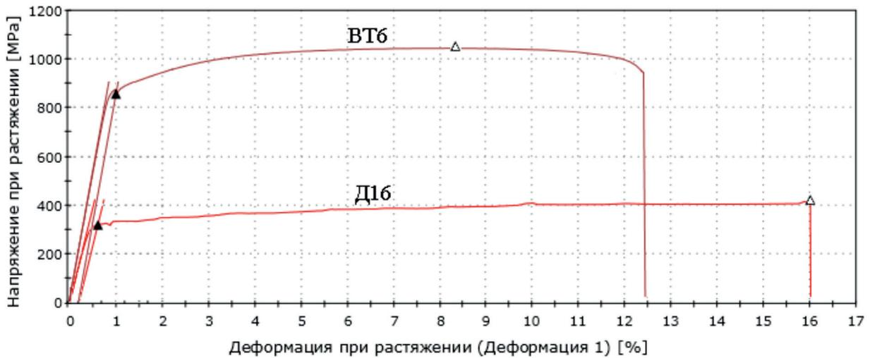
Рис. 2. Диаграммы деформирования при растяжении образцов VT6 и D16
