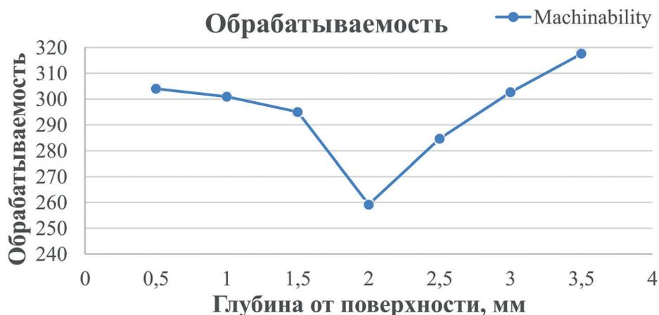
Рис. 3. Обрабатываемость на разной глубине от границы раздела  $M-M$
