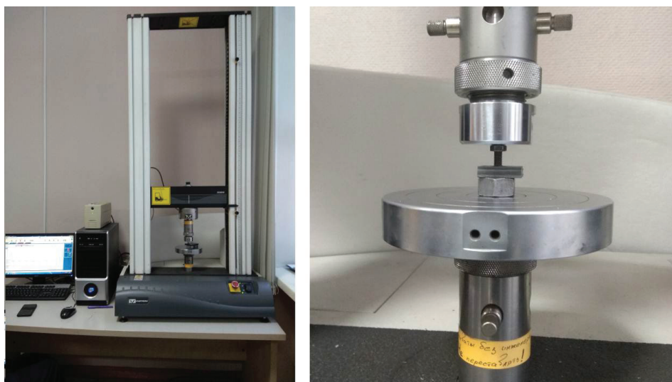
Рис. 2. Испытание прочности резьбового соединения (испытательная машина 3369 Instron)
