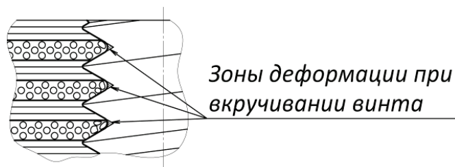
Рис. 6. Схема смятия острых кромок резьбы при вкручивании винта в деталь из углепластика
