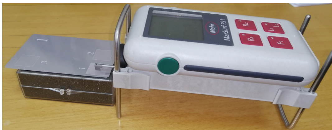
Рис. 3. Измерение шероховатости обработанной заготовки
