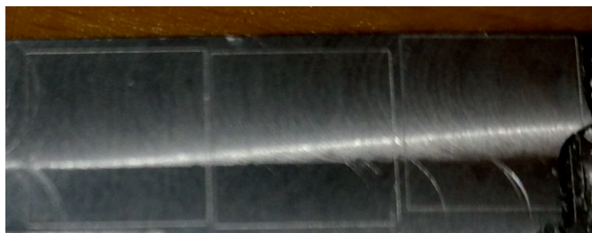
Рис. 5. Фрагмент фрезерованной заготовки с областями, подвергшимися лазерной обработке
