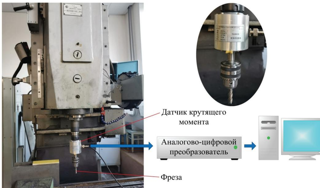
Рис. 1. Принципиальная схема экспериментальной установки
