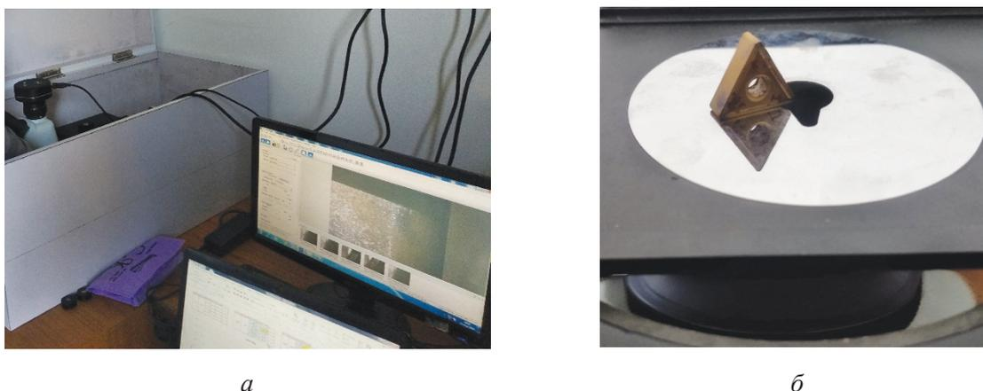
Рис. 5 Цифровой микроскоп для измерения износа по задней поверхности пластины инструмента (10x):
