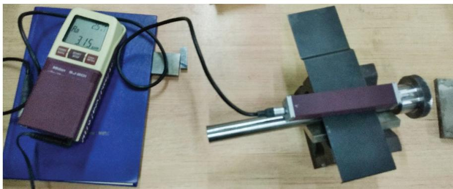
Рис. 6. Измерение шероховатости поверхности
