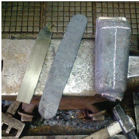
Рис. 5. Образцы белого чугуна БЧ27А послековки
