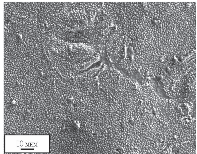
Рис. 2. Ячеистая структура поверхности электровзрывного композиционного покрытия системы Cu-Mo, модифицированного высокоинтенсивным электронным пучком. Сканирующая электронная микроскопия во вторичных электронах
