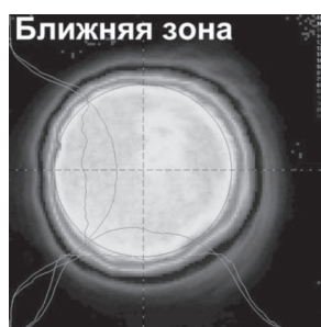
Рис. 2. Форма лазерных импульсов (а) и распределение интенсивности луча системы генератор-усилитель (б)
