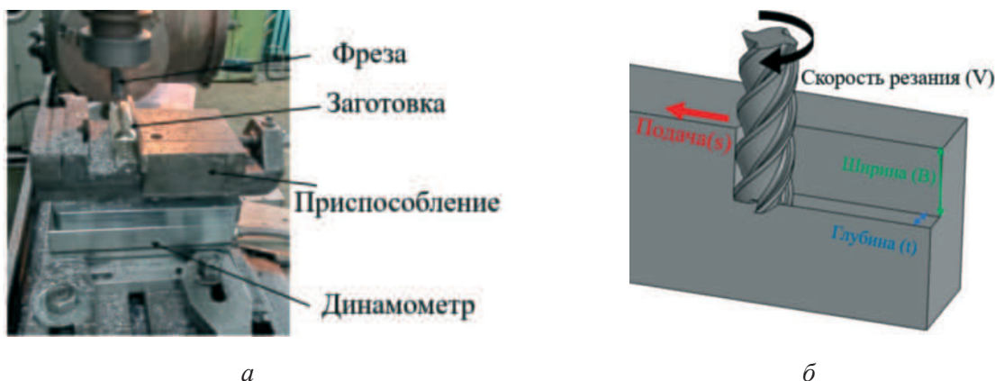
Рис. 2. Общий вид установки, закрепленной на стационарном станке (а), схема фрезерования (б)
