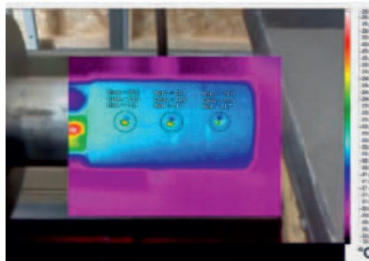
Рис. 7. Верификация показаний температуры, получаемых с термодпар по тепловизору FLUKE Ti400:
