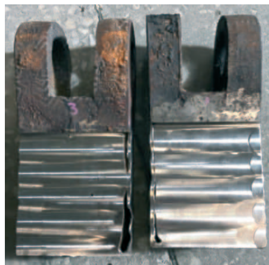
Рис. 5. Протяженные сквозные дефекты бил № 1, 3 (см. рис. 3)
