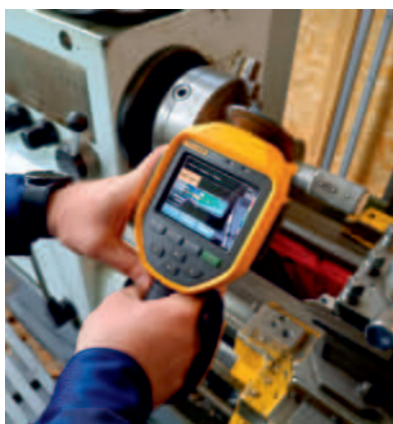
Рис. 7. Верификация показаний температуры, получаемых с термодпар по тепловизору FLUKE Ti400:
