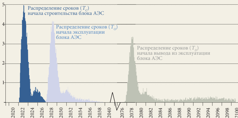
Рис. 3. Распределение плотностей вероятности временных характеристик жизненного цикла энергоблока АЭС (%)
