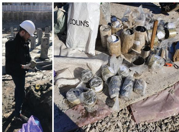
Рис. 2. Создание грунта нарушенной структуры (а); отбор грунта ненарушенной структуры (б)
