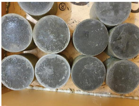
Рис. 7. Образцы, замороженные без утепления (слева) и с утеплением (справа)
