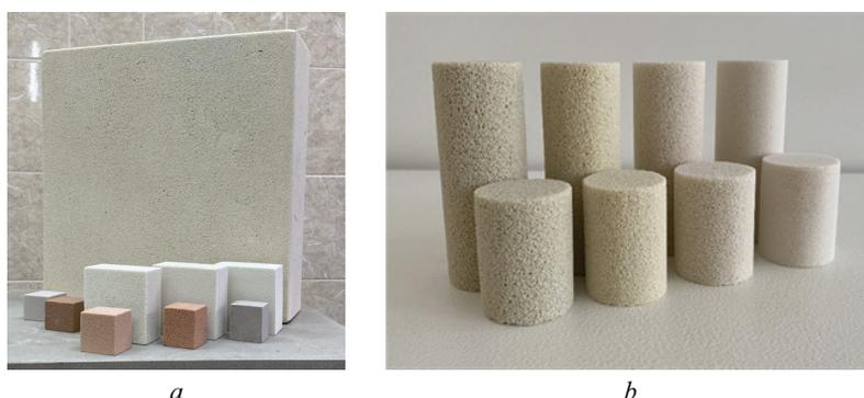
Рис. 1. Фото образцов ПСК (а) и образцов, подготовленных для испытания в импедансной трубе (б)
