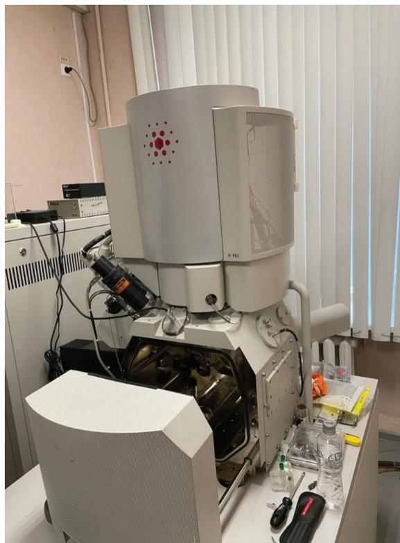
Рис. 3. Электронный микроскоп Versa 3D
