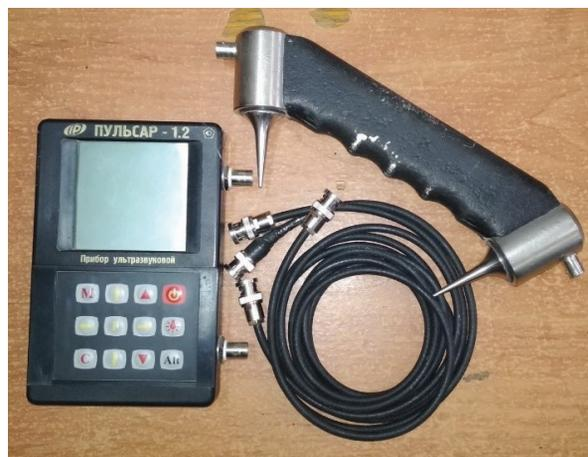
Рис. 2. Ультразвуковой прибор Пульсар 1.2
